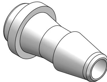
INSTRUMENT QUALITY PART. NO PARTING LINE PERMITTED ON THIS CONICAL SURFACE
