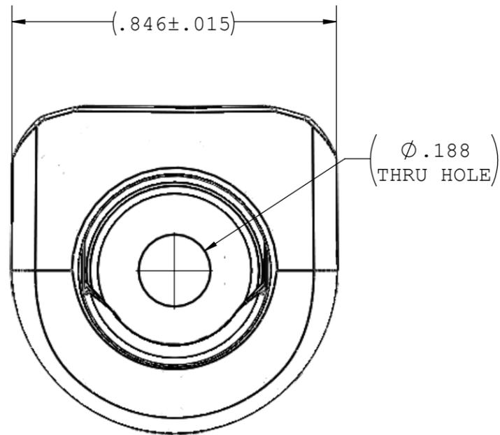
INSTRUMENT QUALITY PART. NO PARTING LINE PERMITTED ON THIS CONICAL SURFACE
