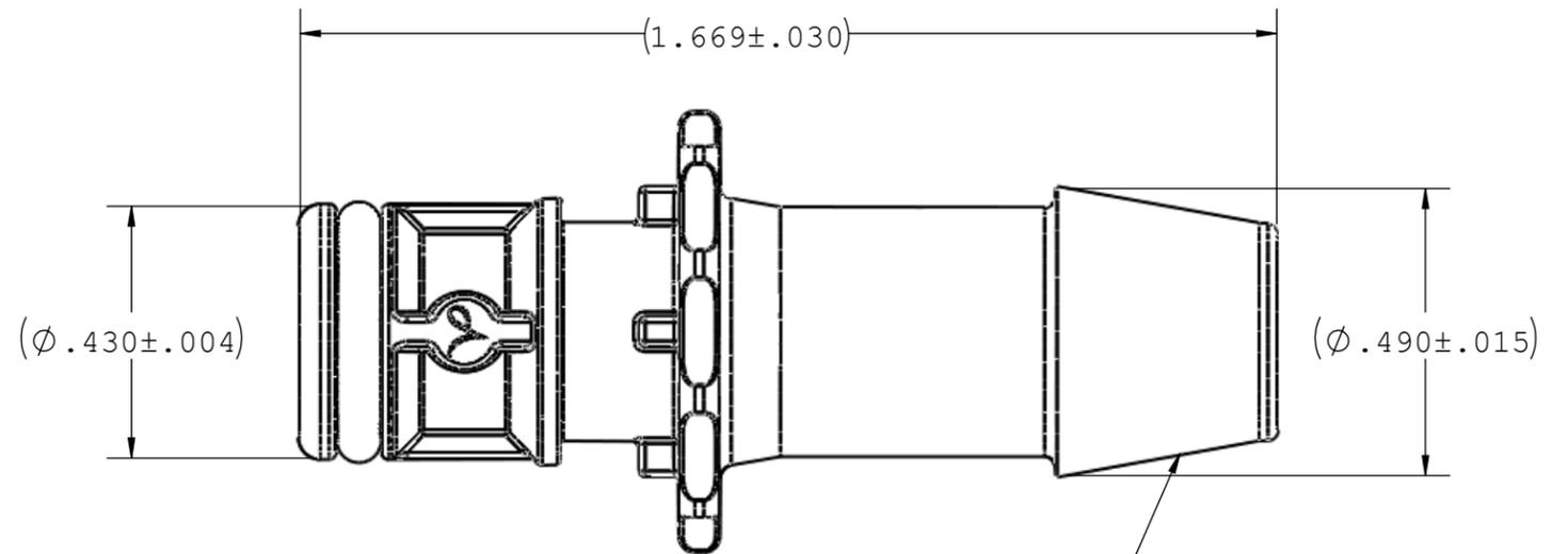
INSTRUMENT QUALITY PART. NO PARTING LINE PERMITTED ON THIS CONICAL SURFACE
