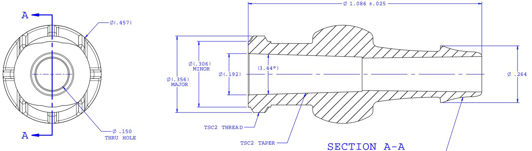
INSTRUMENT QUALITY PART. NO PARTING LINE PERMITTED ON THIS CONICAL SURFACE
